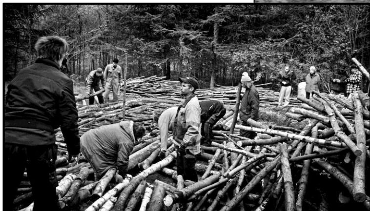
Ett gigantiskt parti plockepinn? Sökande efter en nål i en timmerhög? Nejdå, här byggs rosten (bottnen) till milan, vårt största dragplåster bland aktiviteter.
